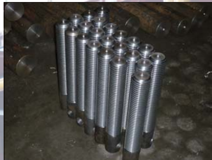
LEFT / RIGHT TRZ THREAD FOR TURNBUCKLE
